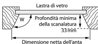
Il montaggio del dispositivo si effettua sempre nella scanalatura.
