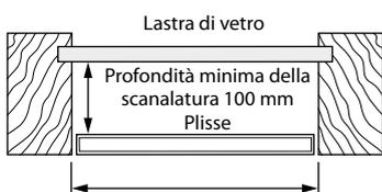
⚠ Per la lunghezza (dimensione H) tener conto del foro d'aerazione in alto e in basso e della larghezza del profilo di montaggio. Per prendere le misure precise, consigliamo di montare prima di tutto il profilo di montaggio.
