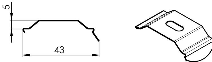
Supporto superiore del box per il montaggio al telaio, PVC (6-016310-xxxx)
