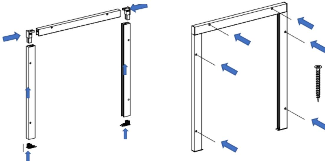
1. Assemblare i profili di guida superiore e laterale nel telaio.
